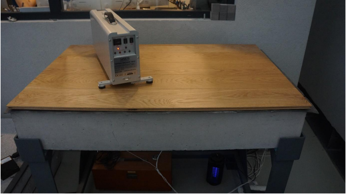
Şekil 4.3 Ölçüm Cihazı 2. Konumdayken Parke Altında Deney Anı
